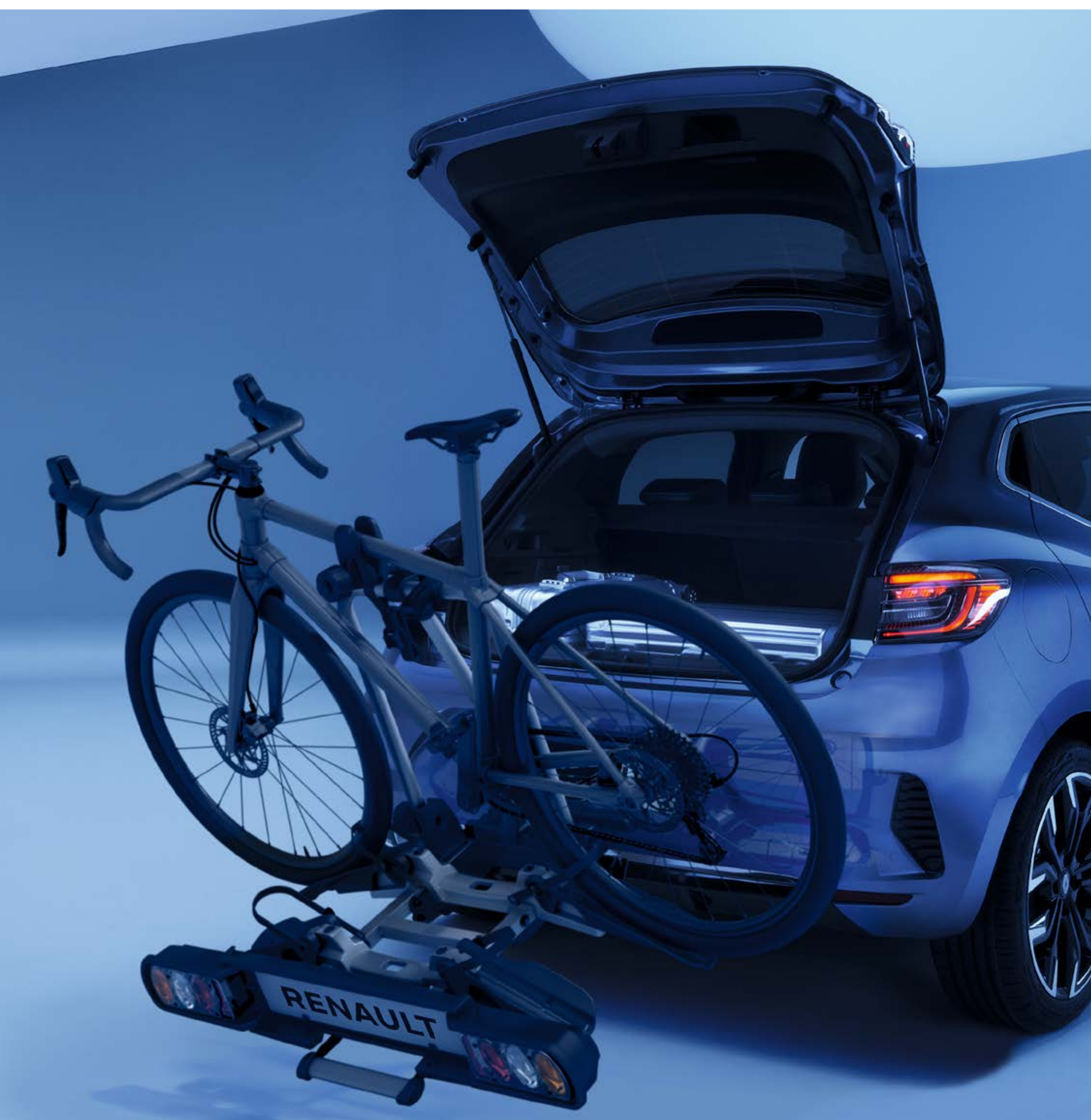
βάση ποδηλάτου στον κοτσαδόρο - ημι-ηλεκτρικός κοτσαδόρος
