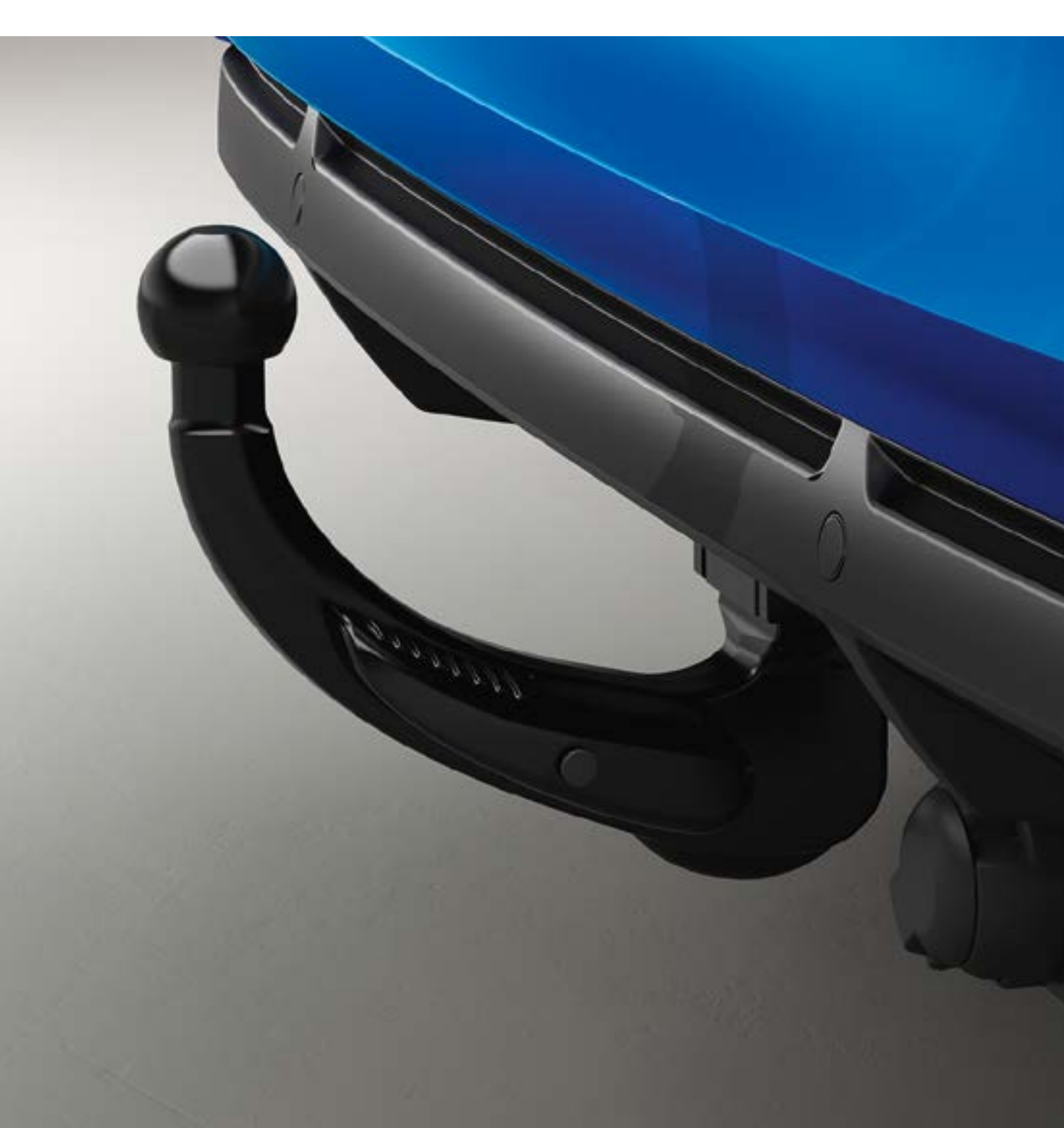
κοτσαδόρος αφαιρούμενος χωρίς εργαλεία
